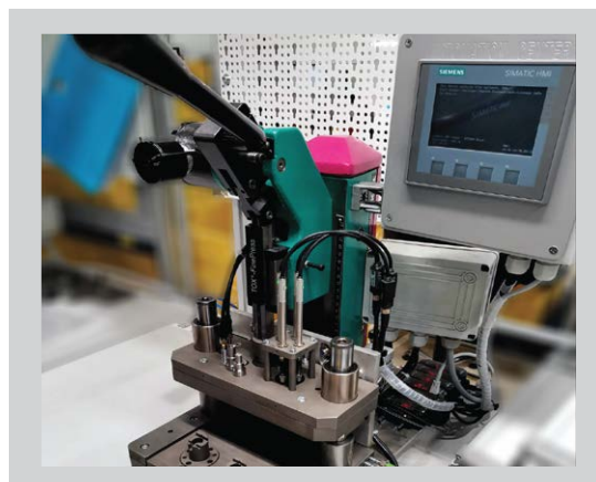
Presa mecanica, ce include verificare precisa a adâncimii de asamblare
