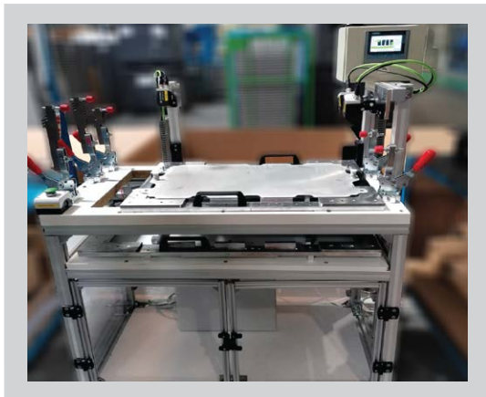
Dispozitiv de verificare cu Poka yoke si camere
